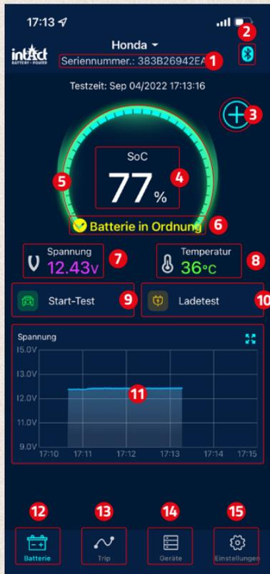
11. Verlaufsgrafik der Batteriespannung: Klicken Sie auf die Grafik, um diese zu vergrößern. Die Grafik zeigt Ihnen wahlweise den Ladezustand in %, die Temperatur oder die Batteriespannung in Volt an. Hier können Sie zwischen der Anzeige eines Tags, 3 oder 5 Tagen wählen. Außerdem können Sie oben mittig zwischen den Tagen wechseln.
