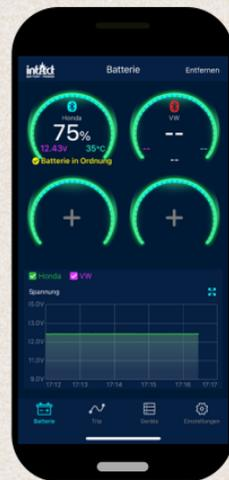
Das Produkt wird zur Überwachung der Autobatterie, des Startsystems und des Ladesystems eingesetzt. Nachdem das Gerät an der Batterie angeschlossen wurde, kann es via Bluetooth 5.3 mit Ihrem Smartphone verbunden werden. Wenn Probleme an der
