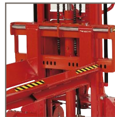
Fassgabeln werden an einem speziellen Gabelträger angebaut.
