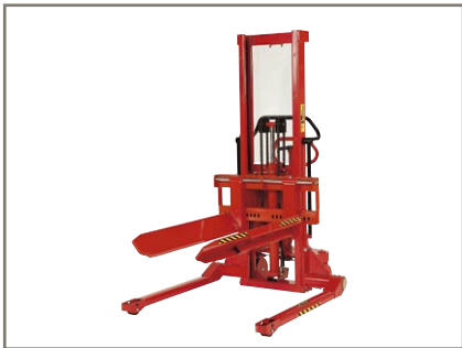
Fassgabeln - eine gute Alternative, wenn liegende Fässer zu heben und transportieren sind (nicht mit Schnellwechsel-System).
