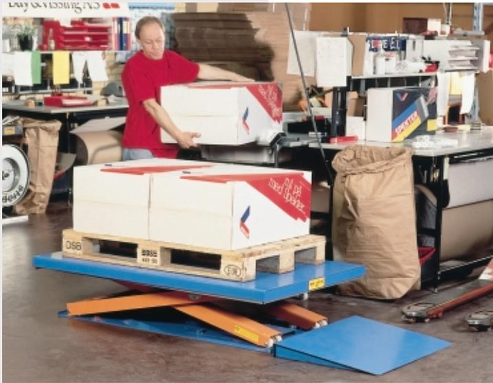
Translyft Hubtische des Typs TCB gibt es in 9 Standardgrößen mit 600 bis 2000 kg Tragfähigkeit und mit Nutzhüben von 550 bis 900 mm, d.h. mit maximalen Tischhöhen von 630 bis 980 mm.
