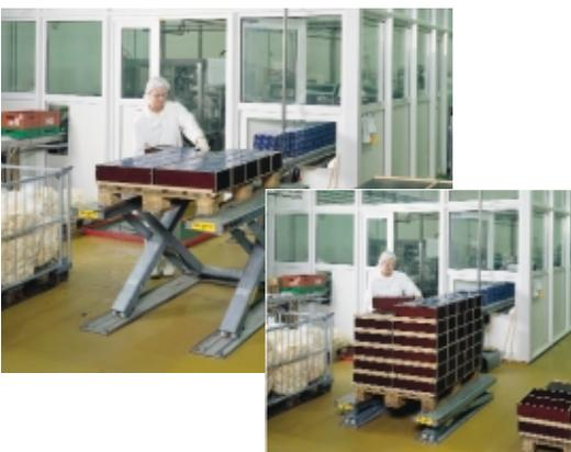
Das Bild oben zeigt einen feuerverzinkten, U-förmigen Hubtisch in der Packerei einer Molkerei. Die einfache Höhenanpassung bietet der Bedienperson ständig die optimale Arbeitshöhe beim Umladen der Pakete vom Band auf die Palette. Ist die Palette voll, so wird sie einfach mit einem herkömmlichen Hubwagen abtransportiert.
